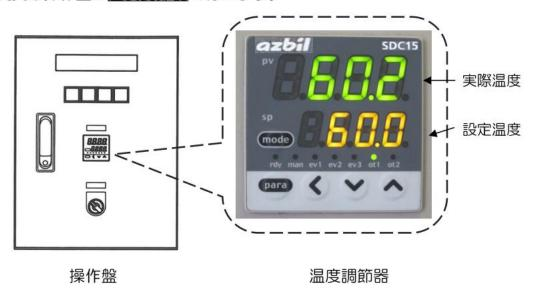
設定温度変更方法 (設定温度60℃を40℃に変更する例)
